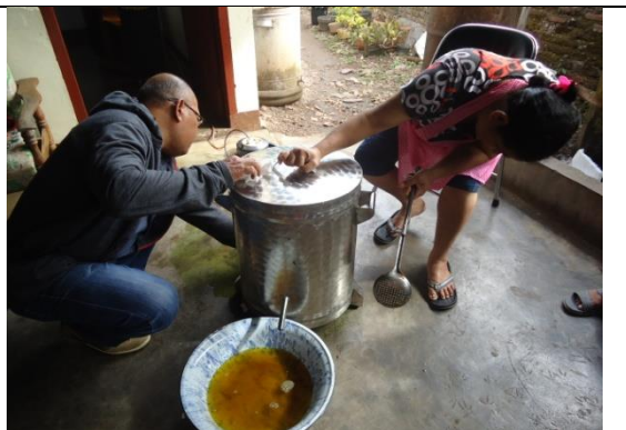
Gb.6 Proses pengeluaran minyak dari mesin pengering
