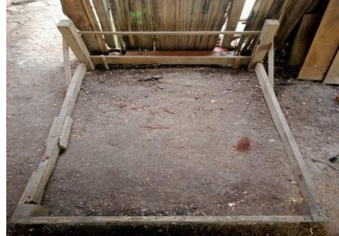
Foto 9. Bingkai Tenun. Alat ini terbuat dari kayu balok yang berfungsi untuk menempatkan tenun.
