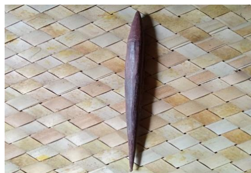
Foto 1. Ike alat ini terbuat dari kayu dan berfungsi untuk memintal kapas menjadi benang.
