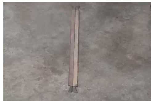
Foto 17. Atis . Alat ini terbuat dari kayu dan berfungsi untuk menaikkan dan menurunkan benang.
